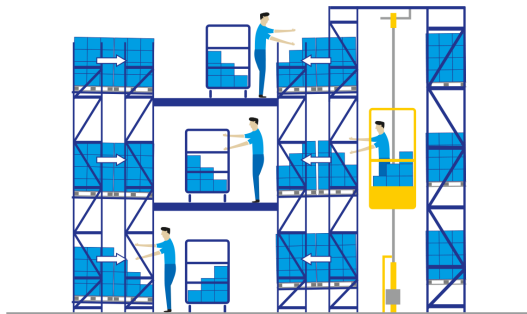
Aplicación de entreplanta
